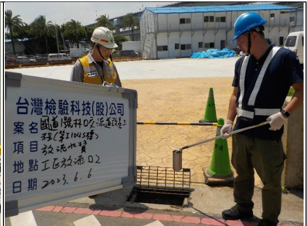
監測項目：放流水質 監測日期：2023.06.06 監測地點：工區放流口 2
